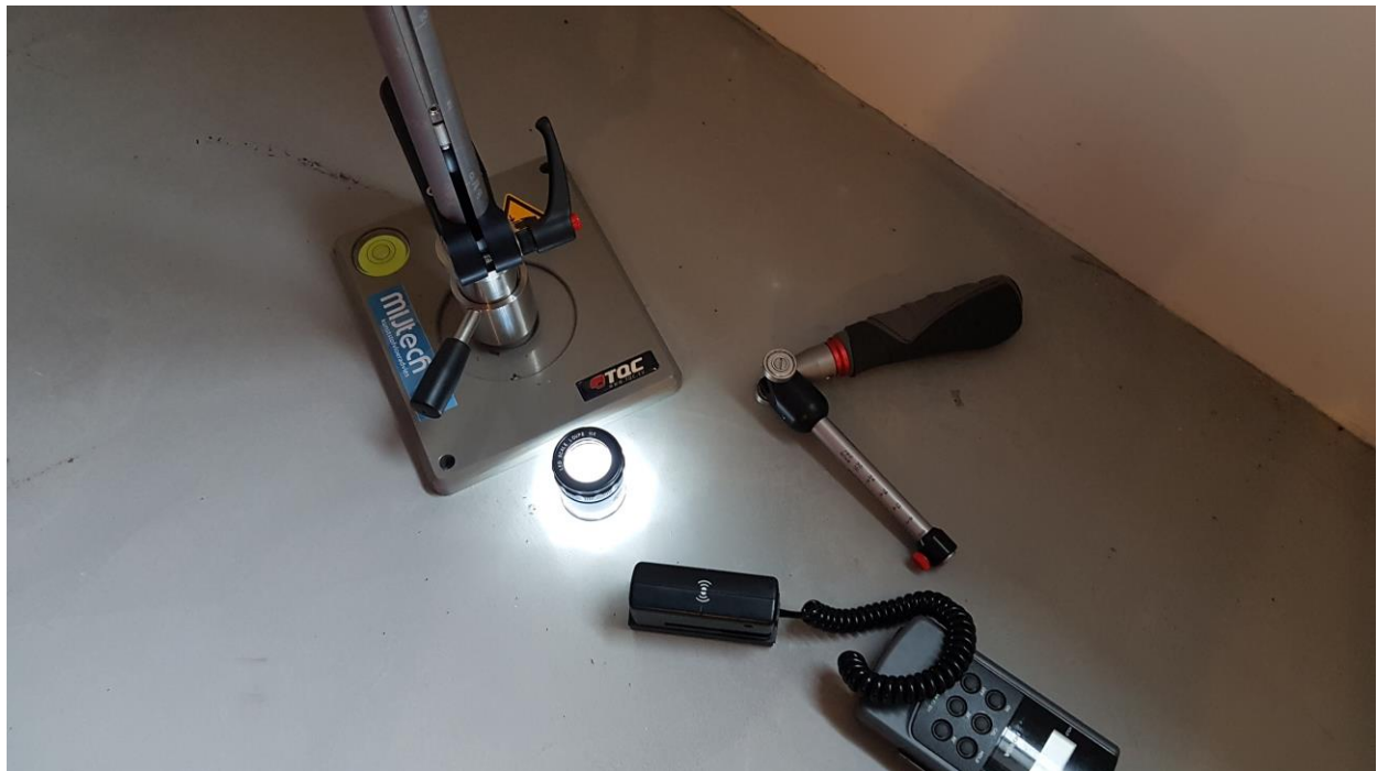
Gebruikte apparatuur voor impact, glansgraad en krasvastheid.
